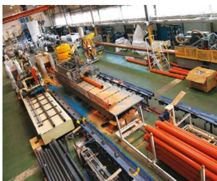
Linia technologiczna PVC-U
