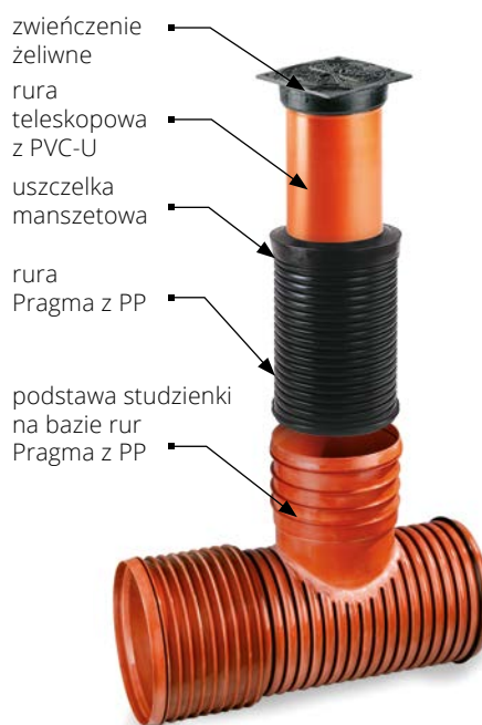
Studzienka Pipelife wykonana na bazie rury Pragma lub Pragma*ID z PP-B
