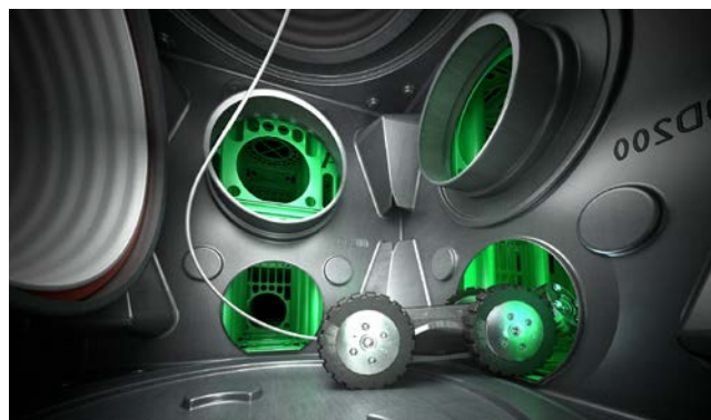
Inspekcja zbiornika poprzez studzienkę kontrolną 600 mm
