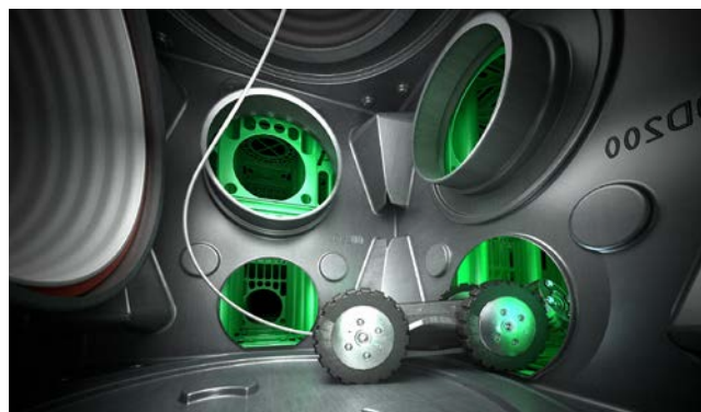
Inspekcja zbiornika poprzez studzienkę kontrolną 600 mm
