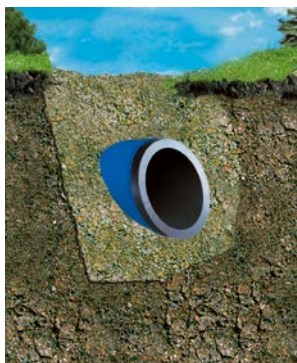
Układanie rur PE 100 RC bez obsypki piaszczystej
