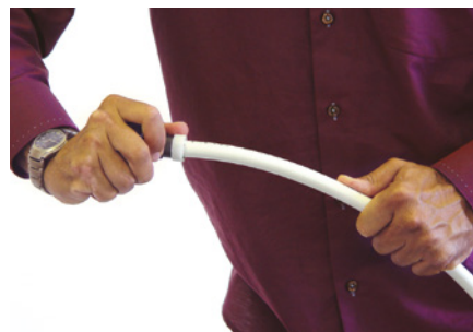
2. Kalibracja i fazowanie rury za pomocą kalibratora.
