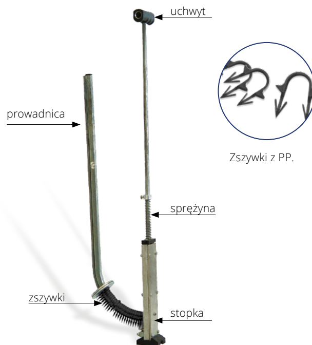
Zszywacz – urządzenie do montażu rur.
